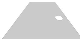
Подкладки-клинья под стеклопанель, 4 шт. (толщина 5 мм, ширина 16 мм)
